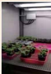
Dos cámaras climáticas visitables dotadas de control de temperatura, fotoperiodo y humedad.
